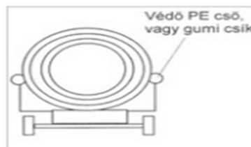
6. ábra Csőtekerecs szállítása „puha” oldalsó megtámasztással
